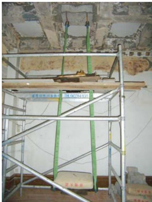
圖 69. 工人在現場做沙漿承載力試驗
