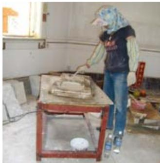
圖 126. 倒模後在震動台振盪
