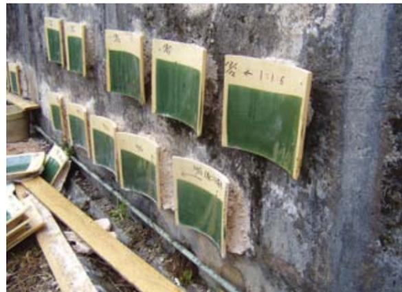
圖 51. 各種配比沙漿的黏合力試驗
