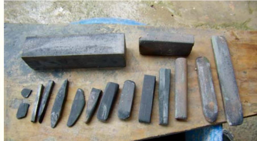
圖 66. 水磨石工藝採用的研磨工具
