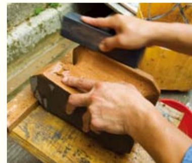
圖 67. 水磨石預製件的研磨
