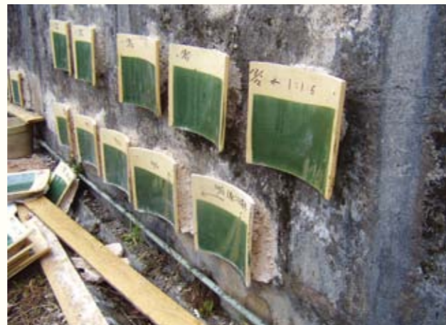
圖 51. 各種配比沙漿的黏合力試驗
