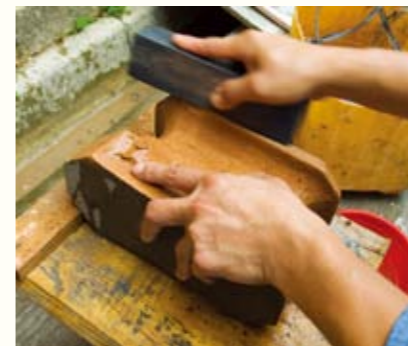
圖 67. 水磨石預製件的研磨
