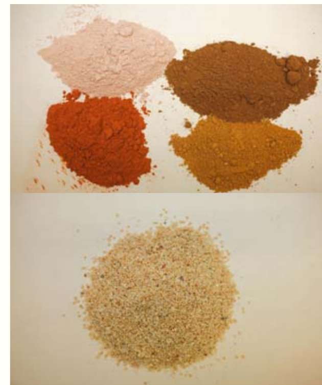
圖 122. 調配彩色水磨石的色粉（上圖）和珍珠沙（下圖）
