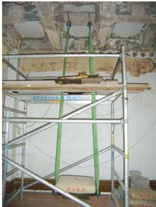
圖 69. 工人在現場做沙漿承載力試驗
