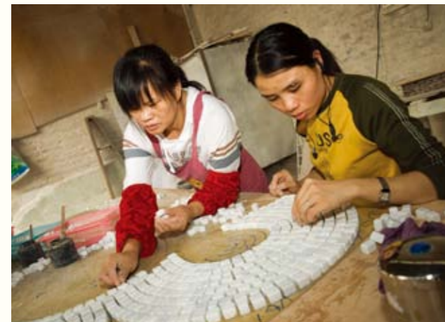
圖 77. 工人正在石廠拼砌雲石馬賽克
