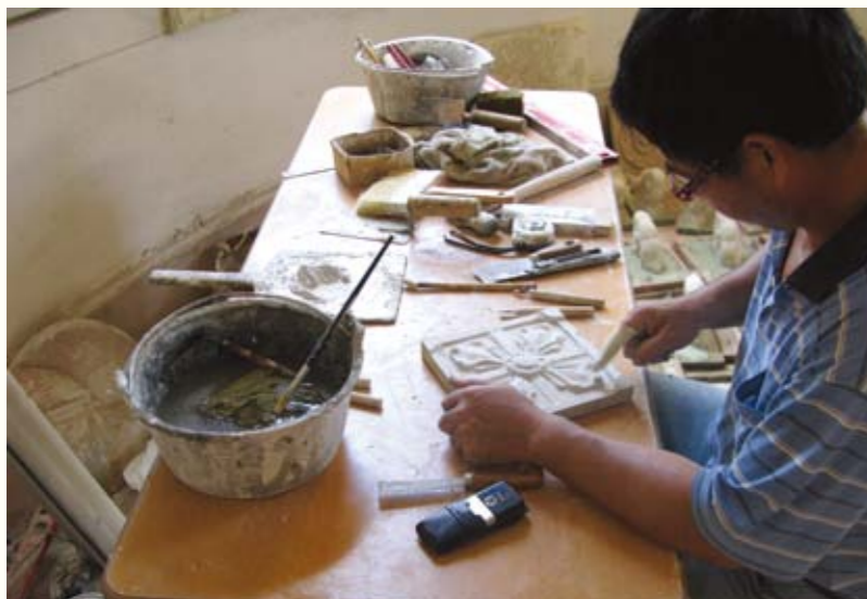
圖 128. 安裝灰塑前修補成品
