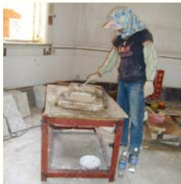
圖 126. 倒模後在震動台振盪
