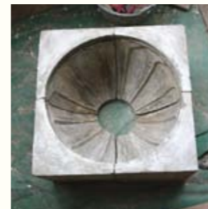
圖 89. 當初製造花盆的英泥模具
