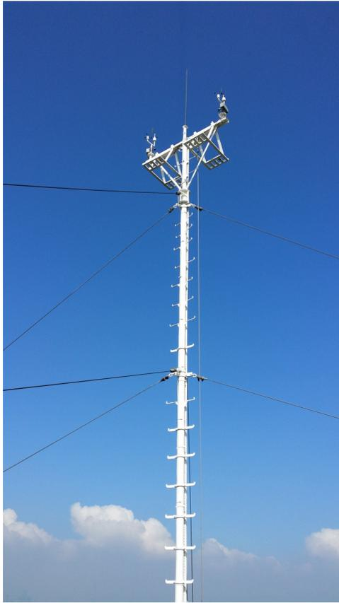
屋頂上現有天文台的儀器（風速計（風傳感器）及其桅杆）
