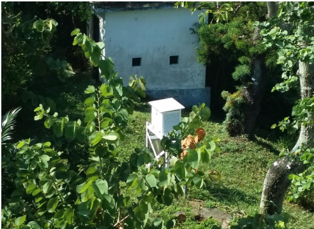
室外天氣監測儀（配有天文台的史蒂遜屏幕，用於室內溫度及濕度傳感器）
